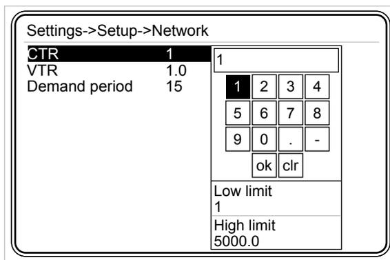
Fig. 3-16 Configuración de índice de transformación de corriente
