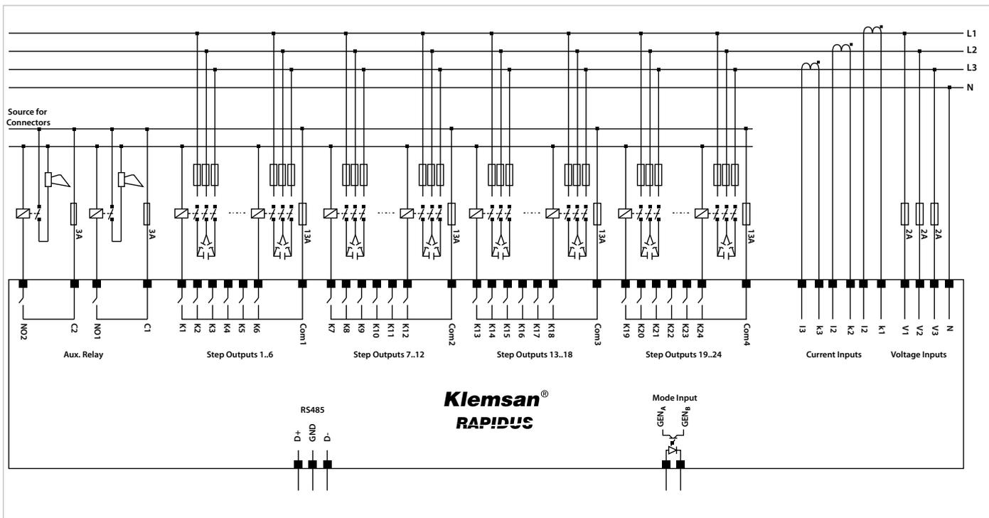
Fig. 2-7 Diagrama de conexión Rápidus (24 Pasos)
