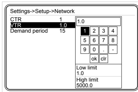
Fig. 3-17 Configuración para Índice de Transformación de Voltaje
