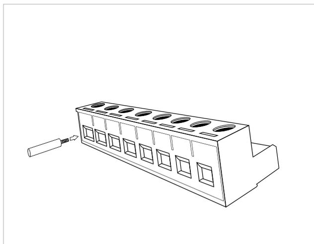
Fig. 2-4 Insertando el cable en el borne
