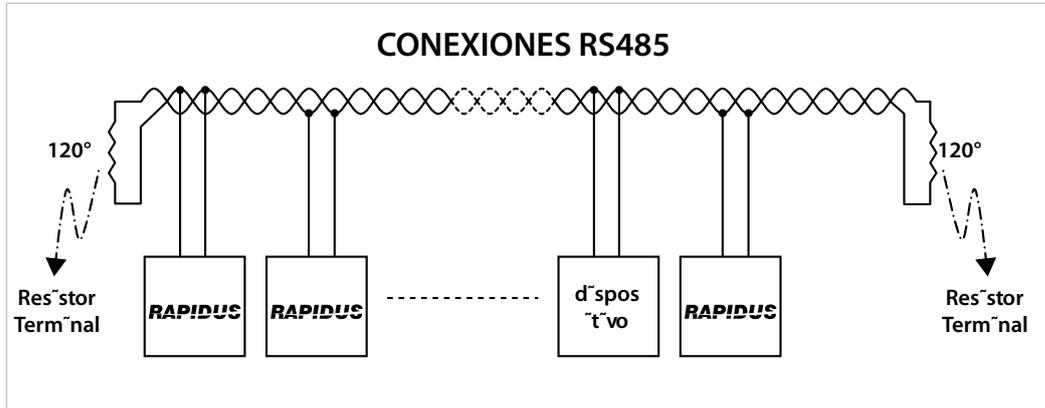
Figure 4-1 Diagrama de Conexiones RS485
