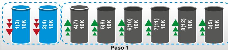
Demanda de -10K, sin embargo, no hay inductores para activar ni capacitores para desactivar y la demanda continúa. UNA ALARMA SERÁ DISPARADA.
