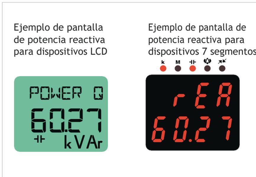
Fig. 3-1 Ejemplo de página de medición instantánea (Potencia reactiva)
