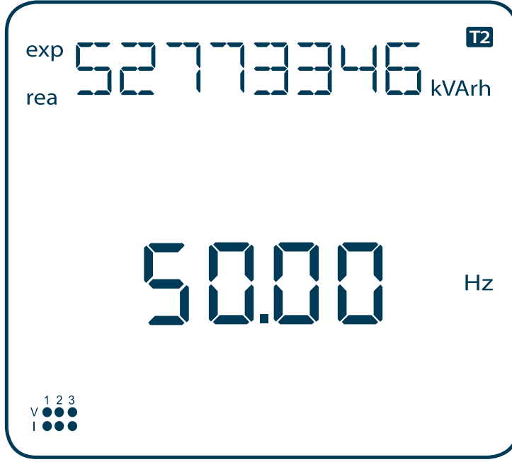
Şekil 3-4 Tarife 2 Export Reaktif Enerji Sayacı Ekran Örneği
