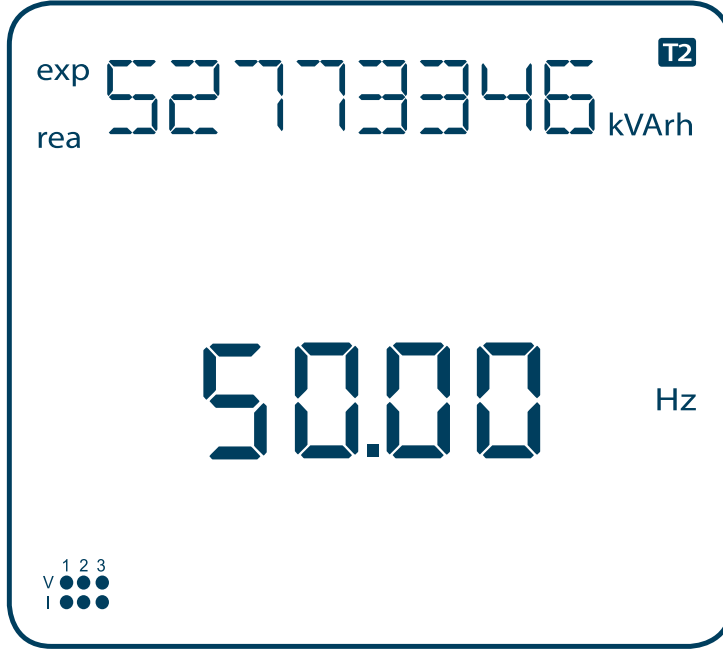
Şekil 3-4 Tarife 2 Export Reaktif Enerji Sayacı Ekran Örneği
